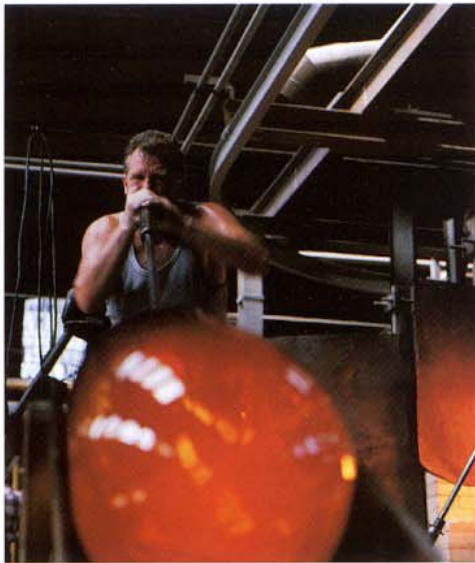
Bild oben: Die Glasmasse wird zu einer Kugel aufgeblasen, dann aufgeschnitten und zur Tafel geglättet.
