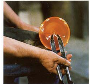
...danach wird sie geöffnet und zu einer kleinen, runden Scheibe gedreht.
