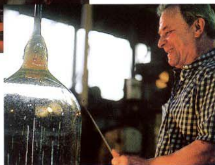
Oben: das Aufblasen der flüssigen Glasmasse zu einem Ballon erfolgt in einer Grube.
