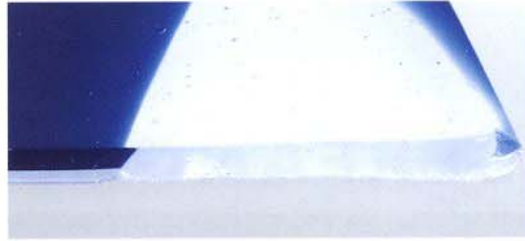
Ein Doppelüberfang: Blau und Opak auf weißem (klarem) Glas. Hier ist deutlich zu sehen, daß das Glas nicht durchgefärbt ist, sondern die Überfänge als Schichten auf dem Trägerglas liegen.
